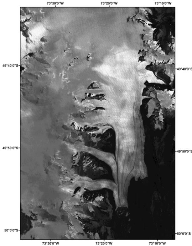
**Figura 7.** Cociente de bandas utilizado para delimitar zonas de ablación y acumulación. Imagen Landsat 5 TM de marzo del 99: banda 4 (NIR) sobre banda 7 (SWIR).
