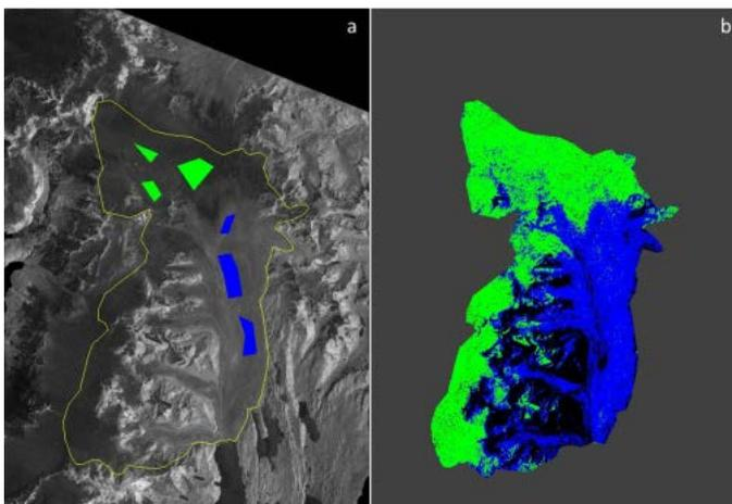
**Figura 9.** Máscara sobre la imagen Sentinel 1A y muestras de clases ablación y acumulación (a) Imagen clasificada (b).
