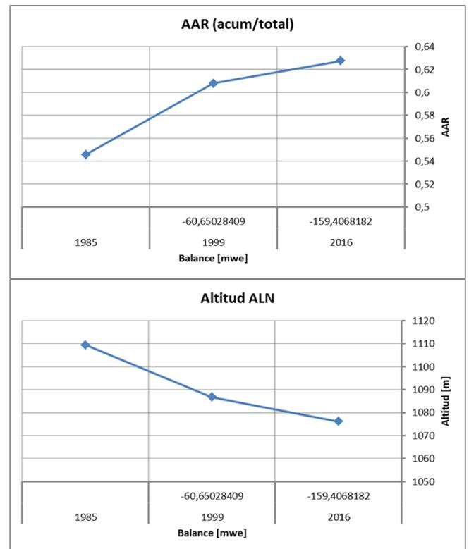
**Figura 15.** Gráfico comparativo del balance de masas con el radio AAR y la altura ALN. Se aprecia la directa relación entre ambos debido al balance negativo.
